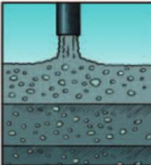
BEIM BETONIEREN HOHER BAUTEILE IST LAGENWEISE EINZUBAUEN. JEDE SCHICHT  $\leq 50$  CM
