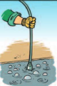
BEI ORDNUNGSGEMÄSSER VERDICHUNG ENTSTEHEN AN DER OBERFLÄCHE LUFTBLASEN.
